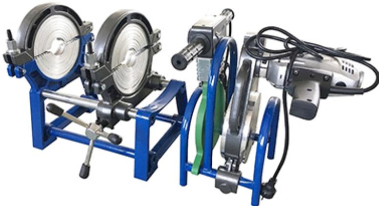
Механический стыковой сварочный аппарат SUD 40-200 M2 с двумя зажимными кольцами. Предназначен для монтажа труб из полиэтилена (высокого и низкого давления) и полипропилена.
